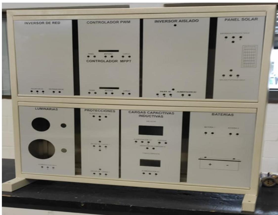
Figura 32. Estructura final entrenador solar fotovoltaico
