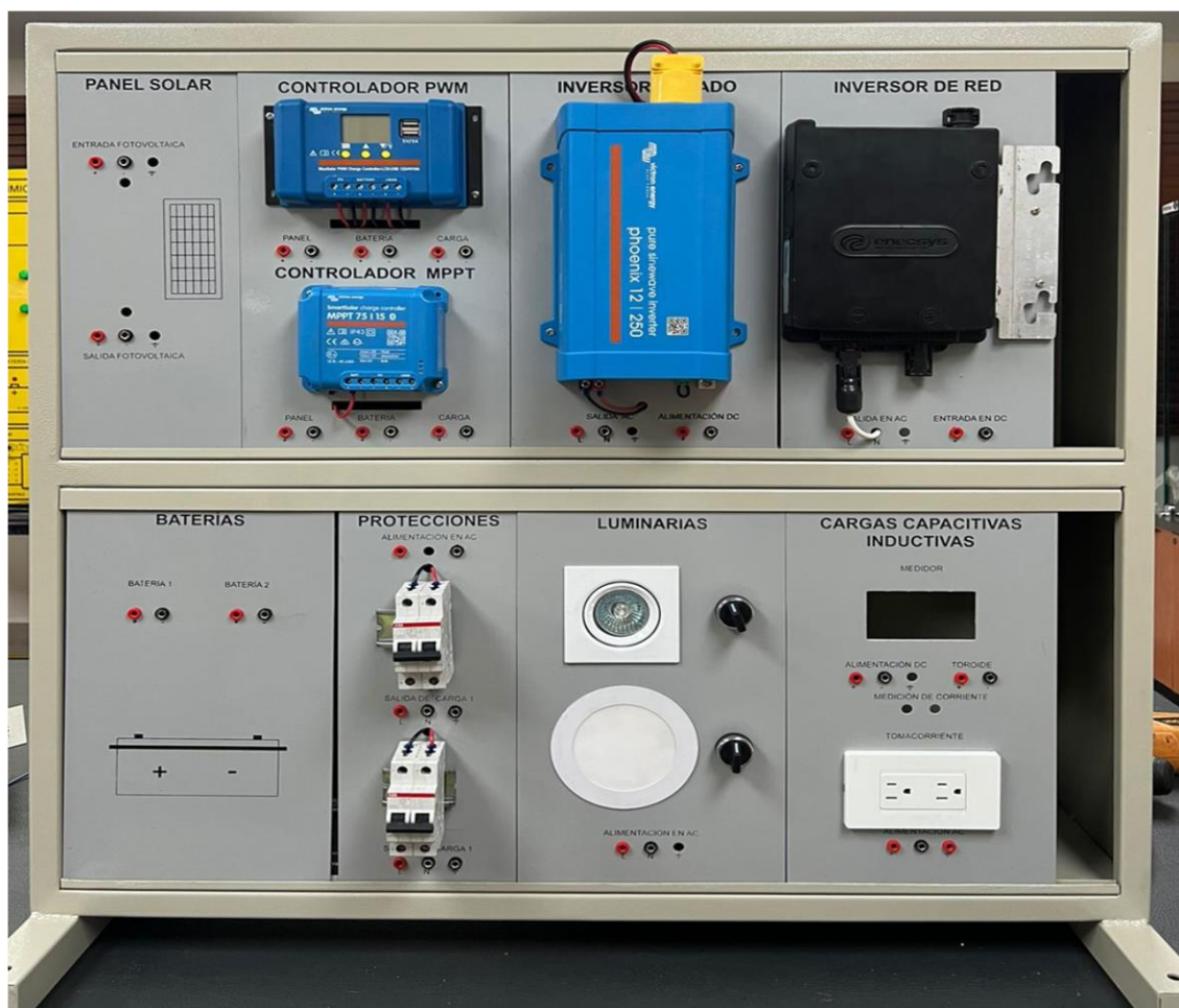
Figura 34. Entrenador solar fotovoltaico con sus componentes.
