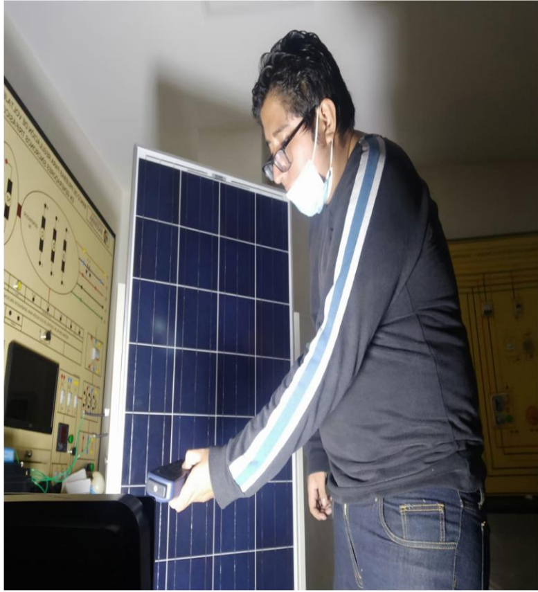
Figura 54. Lectura de irradiación artificial utilizando el piranómetro.
