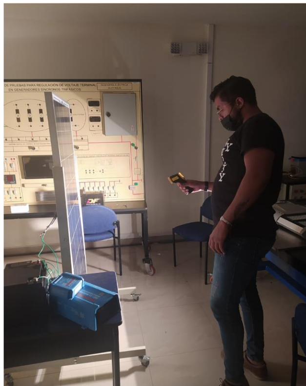
Figura 53. Toma de temperatura al panel fotovoltaico expuesto a lámpara halógena.
