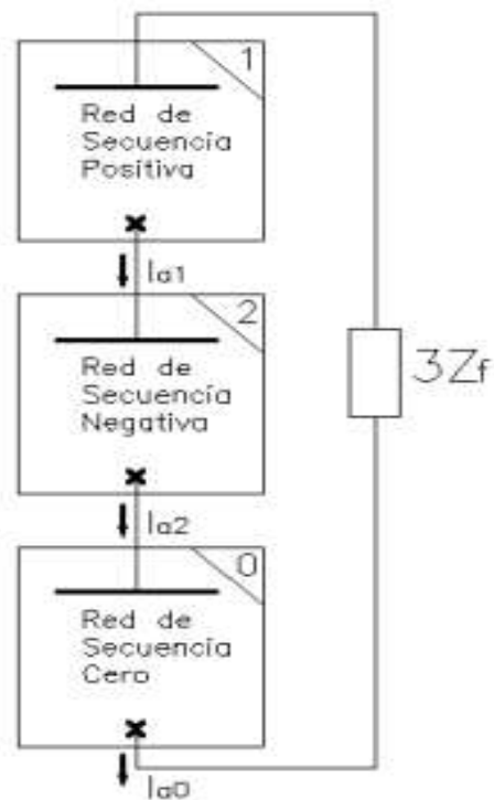
FIG. 3. ESQUEMA DE MODELACIÓN DE LA FALLA MONOFÁSICA (PABÓN 2017)
