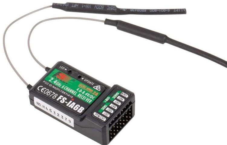
**Figura 22.** Receptor con canales de transmisión y alimentación. [21]
