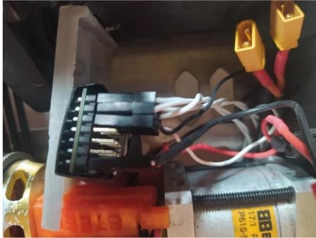
**Figura 53.** Conexión de receptor del radiocontrol a las señales de pines a cada ESC y alimentación a la batería lipo 2S.
