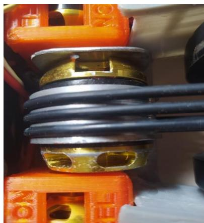
**Figura 51.** Motor brushless acoplado con 3 bandas de aluminio para el arma.
