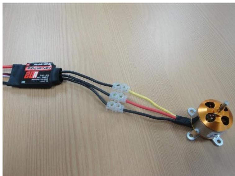
**Figura 14.** Motor brushless conectado a las terminales a un ESC. [17]
