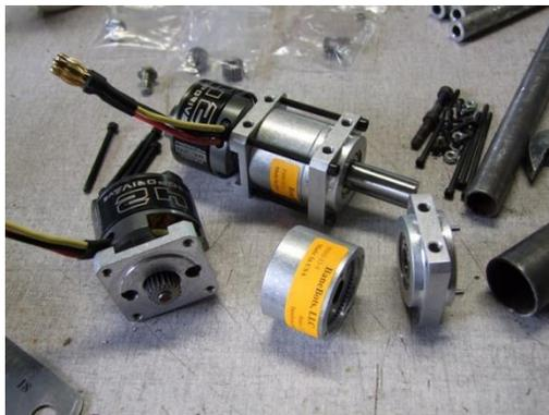
**Figura 10.** Brushless acoplado a caja reductora. [13]
