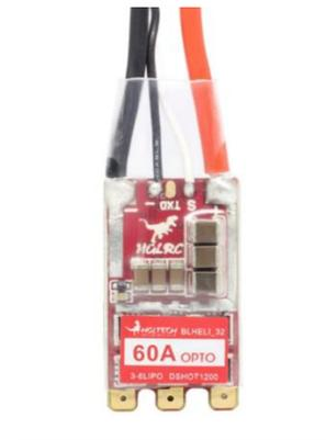
**Figura 37.** Vista frontal ESC 60A HGLRC. [28]
