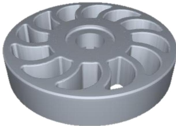
**Figura 32.** Modelamiento de la rueda banebot en vista isométrica. [26]
