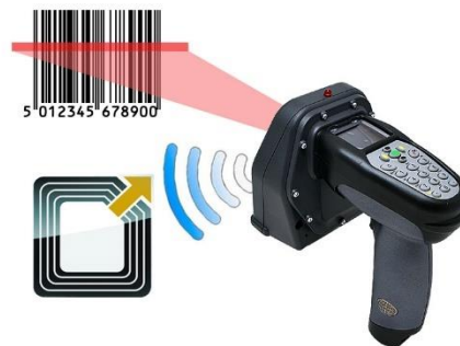
Figure 5 Lectores de etiquetas en un sistema RFID (FQ Ingeniería Electrónica, 2015)
