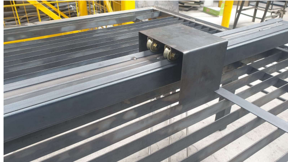
Figura 44. Proceso de ensamble cabezal del eje Z.
