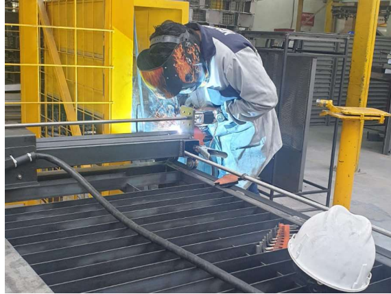
Figura 46. Proceso de soldadura de soportes de motores.
