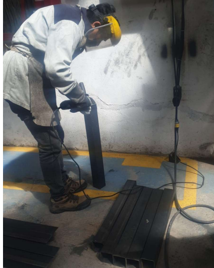
Figura 33. Corte de perfiles estructurales con tronzadora
