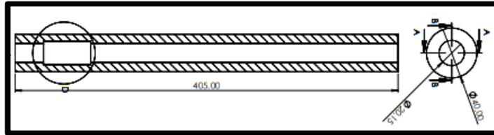
Fig. 32 Dimensionamiento del cilindro.
