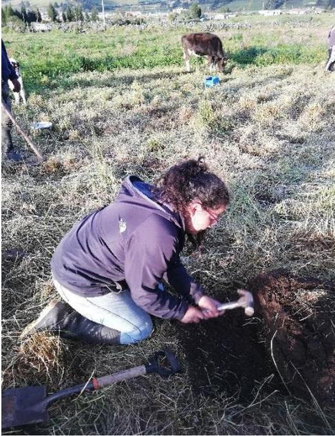
Nota: Compactando la tierra en el cilindro muestreador con la ayuda de un martillo.
