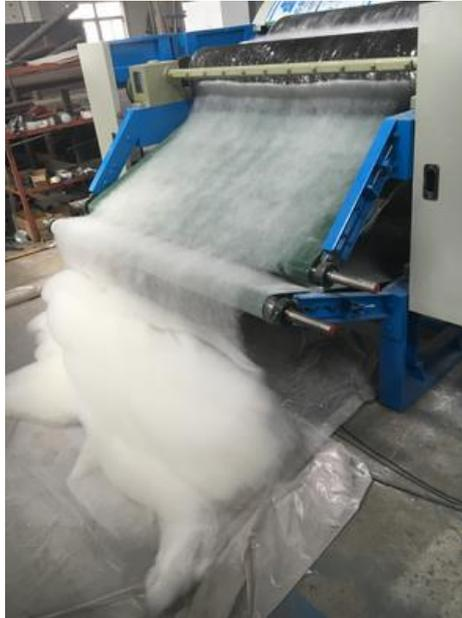
Figura 14. Máquina de fibra PET [66].
