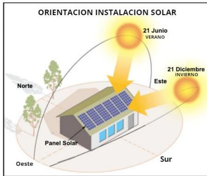
Figura 23. Inclinación y orientación solar óptima para paneles solares [40].
