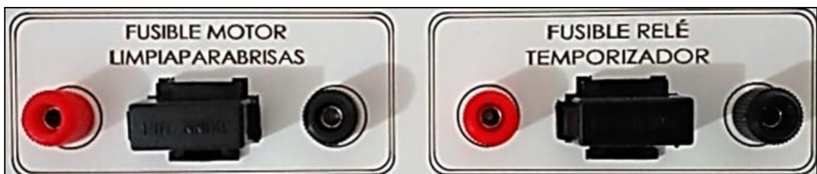
Figura 3.36. Porta fusible de motor limpiaparabrisas y relé temporizador
