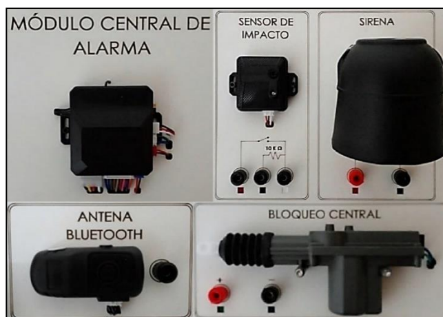
Figura 3.14. Módulo central de alarma, sensor de impacto, sirena, bloqueo central y antena bluetooth.
