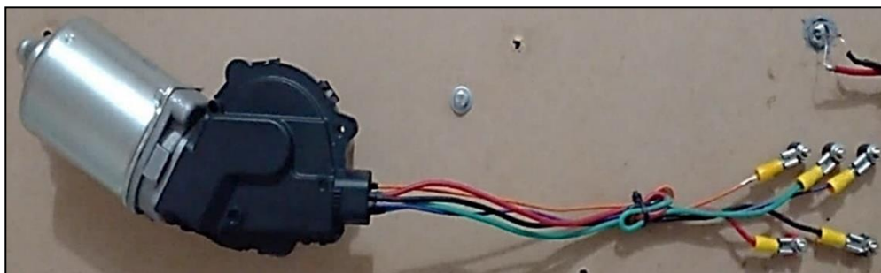
Figura 3.41. Cableado de motor limpiaparabrisas.
