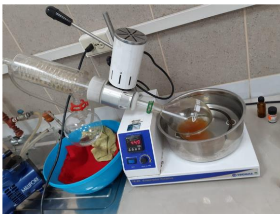
Figura 43 Extracción del solvente por medio del Rotavapor
