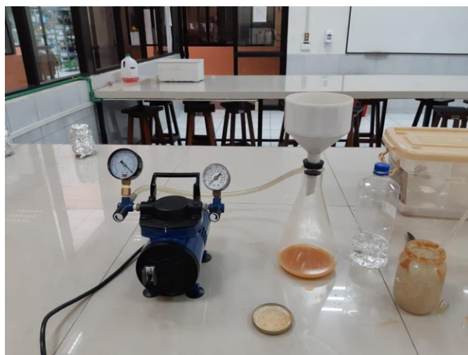
Figura 44 Filtración al vacío de los extractos obtenidos
