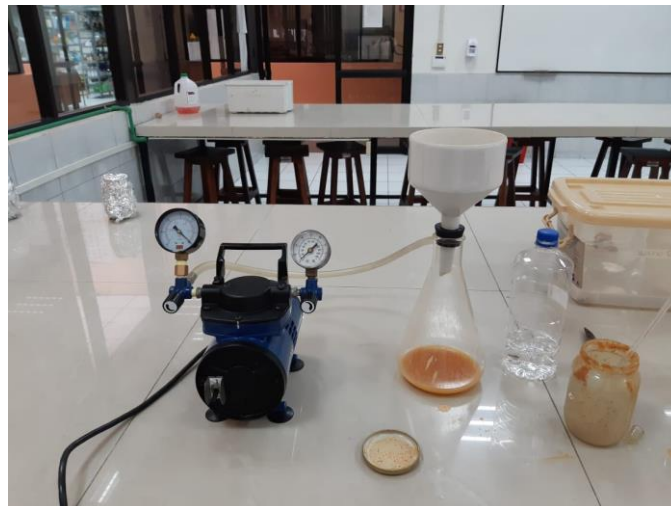
Figura 5 Filtración al vacío de los extractos obtenidos
