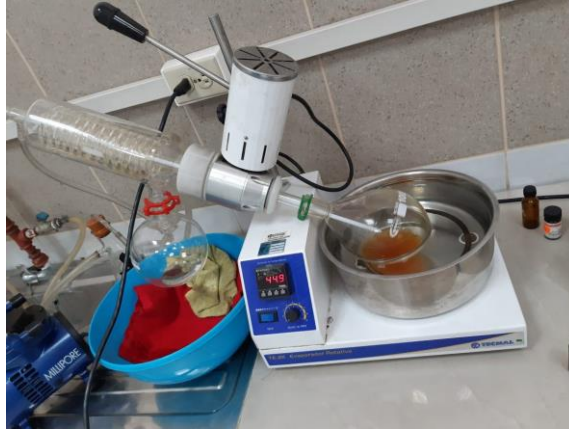
Figura 4 Extracción del solvente por medio del Rotavapor
