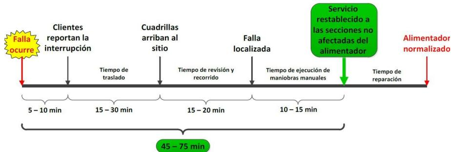
Figura 2.4: Restauración del servicio manual sin FLISR. [2]
