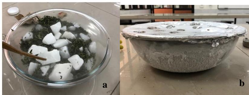
Nota. a) Inmersión de muestra vegetal con solvente y hielo seco; b) Winterización a  $-78^{\circ}\text{C}$ .
