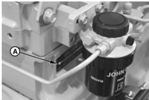
Figura 2.2: Placa de identificación de motor, vista lateral
