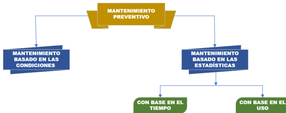
Figura 4: Clasificación del Mantenimiento Preventivo
