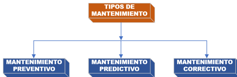
Figura 3: Los tipos de mantenimiento
