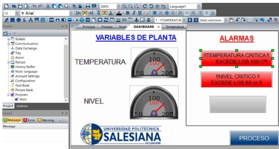
Figura 3.57. Mensaje de alarmas críticas.
