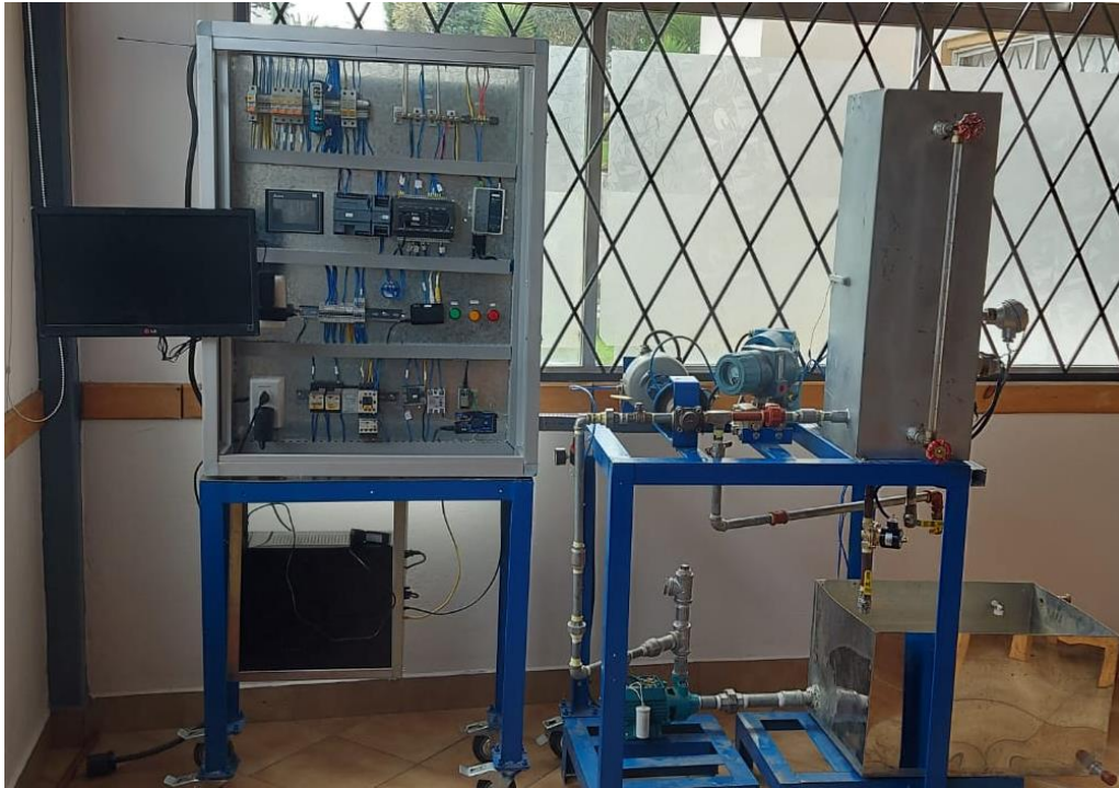
Figura 3.19. Planta de entrenamientos de procesos continuos real.
