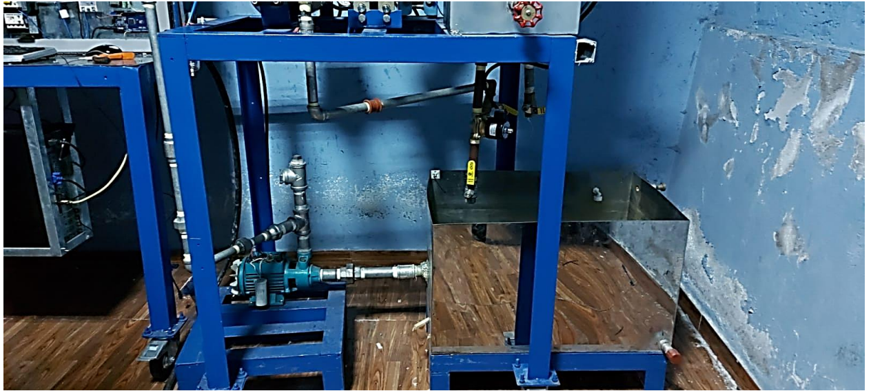
Figura 68. Conexiones del tanque al motor
