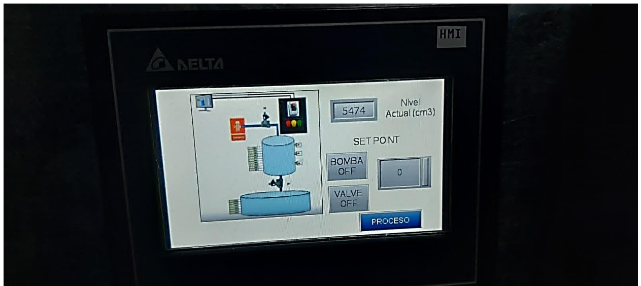
Figura 67. Control de la bomba
