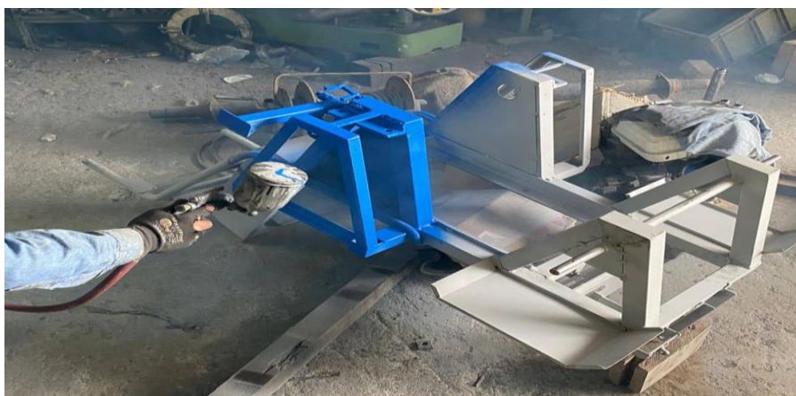
Figura 44. Acabado final bastidor, [Lucero Anghy & Tipán Edwin]
