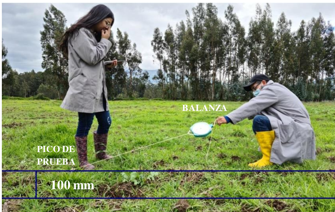
Figura 15. Esquema de pico de pruebas para prueba de dureza, [Lucero Anghy & Tipán Edwin].
