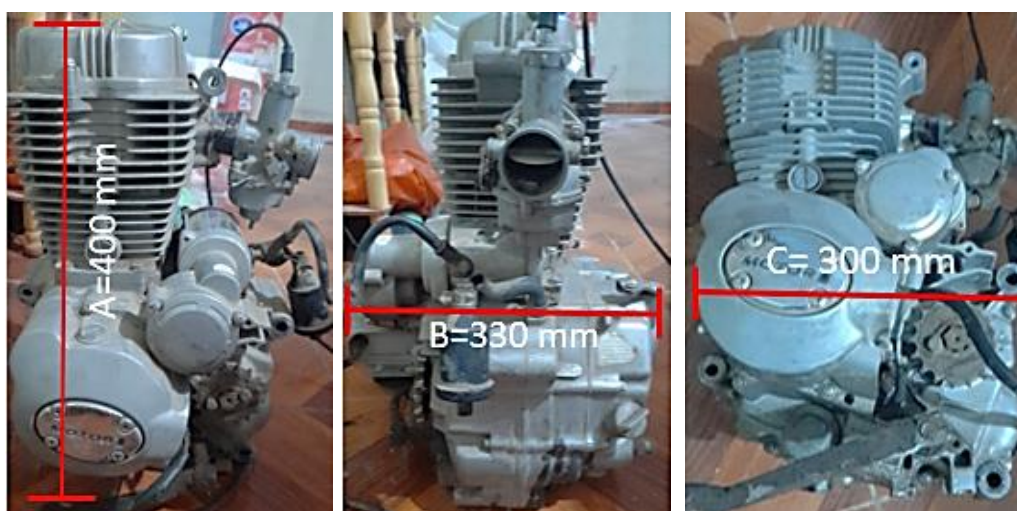
Figura 16. Dimensiones del motor, [Lucero Anghy & Tipán Edwin].
