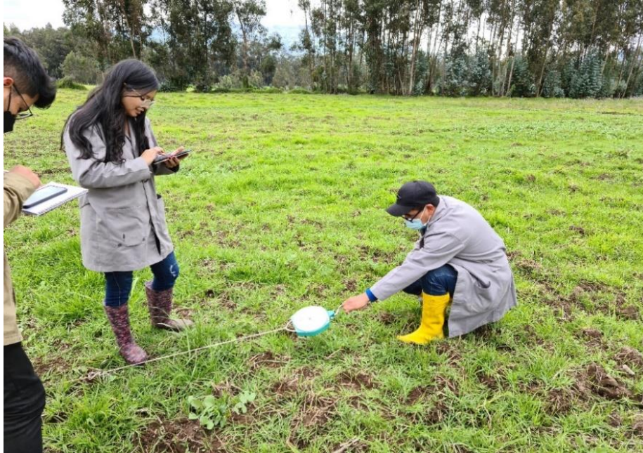
Figura 47. Prueba de dureza en suelo arado, [Lucero Anghy & Tipán Edwin]
