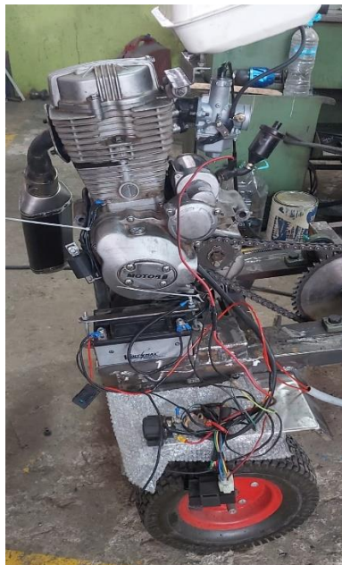
Figura 42. Cableado y conexión de motor, [Lucero Anghy & Tipán Edwin]
