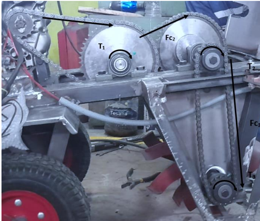
Figura 20. Distribución de fuerzas y torque, [Lucero Anghy & Tipán Edwin]
