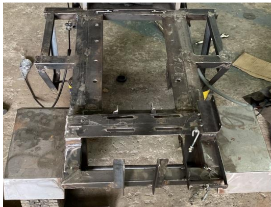
Figura 40. Remate de todas las aristas, [Lucero Anghy & Tipán Edwin]
