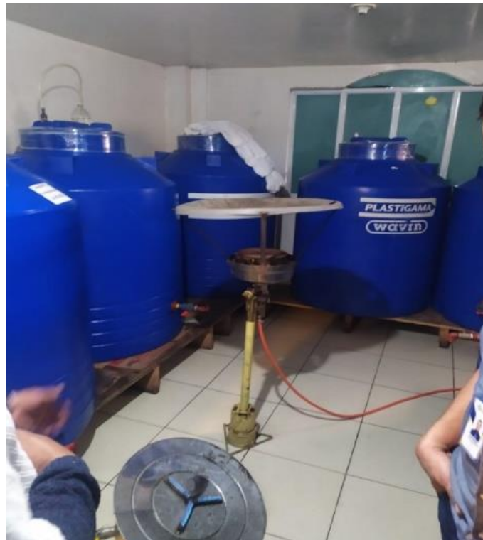
Figura 12. Calentador artesanal para mantener la temperatura ambiental en el rango de 25 a 30 °C.
