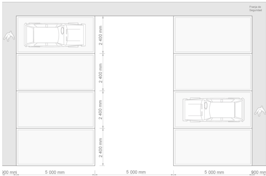
Figura 25. Dimensiones para plazas de estacionamiento a 90° con sección para circulación peatonal tipo cera [37].
