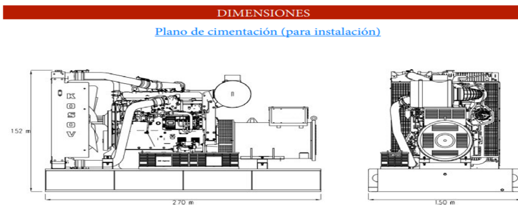
Figura 31. Dimensiones de una planta eléctrica kosov de 225 Kw de capacidad [44].
