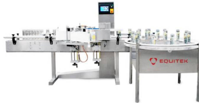
Figura 21. Equipo para etiquetado de envases cilíndricos serie ES-1.
