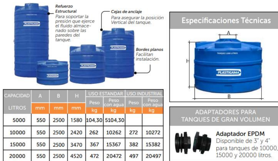
Figura 30. Dimensiones para tanque cilíndrico vertical de gran volumen / uso superficial [30].
