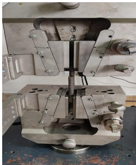
Figura 25. Sujeción probeta soldada.
