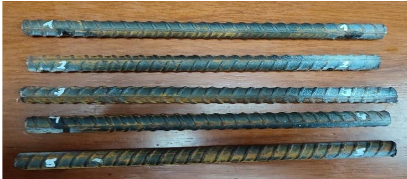
Figura 18. Material base sin aplicación de soldadura.
