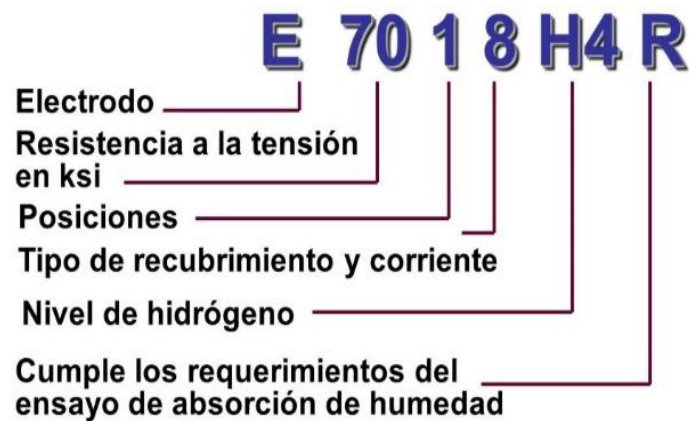
Figura 4. Nomenclatura electrodo [22].
