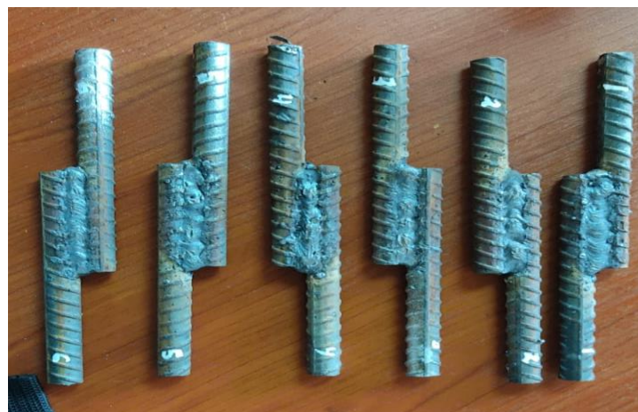
Figura 17. Barras en contacto soldadas por traslape directo.
