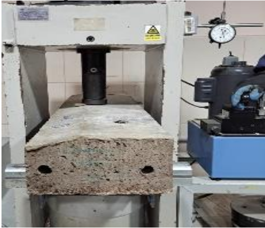
Figura 9.- Bordillo sobre apoyos, cuña y centro de bordillo en máquina de flexión
