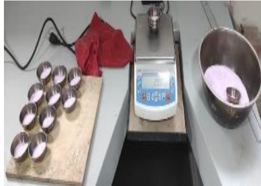
Figura 10.- Aluminio fundido para ensayo de desgaste Böhme
