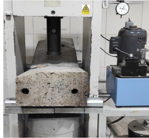
Figura 14.- Bordillo ensayado a flexión
