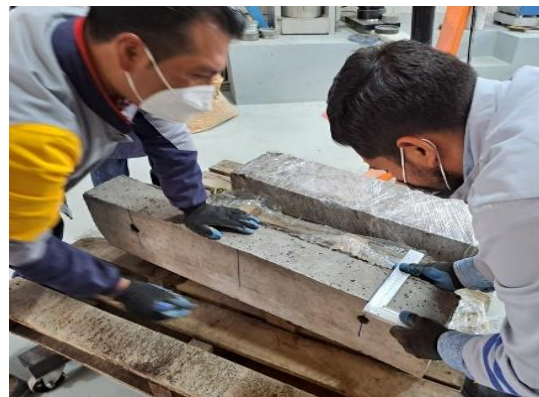
Figura 7.- Señalización de apoyos
