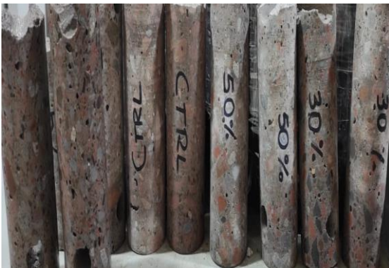
Figura 13.- Núcleos extraídos de bordillos
