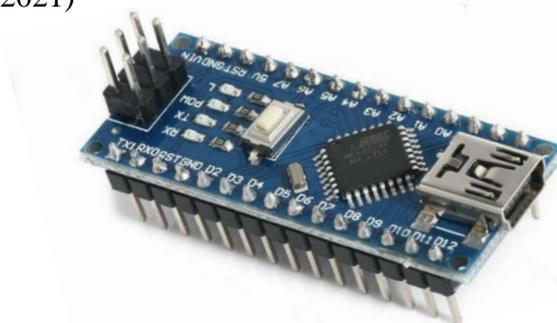
*Figura 53. Microcontrolador Arduino Nano. (Komunicate, 2018)*
