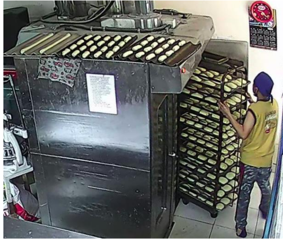
Figura 22. Cámara de fermentación
