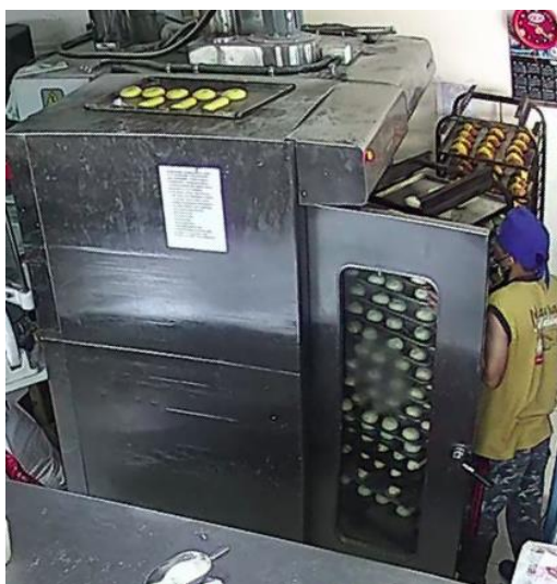
Figura 21. Cámara de fermentación
