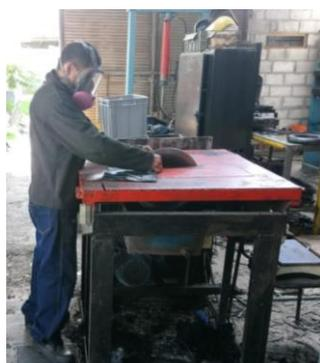
*Figura 16: Cortadora Circular. Fuente: [OQ cauchos].*
