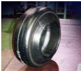
*Figura 8: Forma de un Neumático Verde. Fuente: (Castro,2008).*
