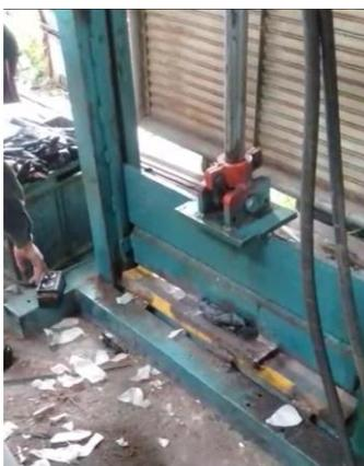
*Figura 15: Guillotina Hidráulica. Fuente: [OQ Cauchos].*
