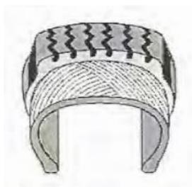
*Figura 4: Neumático Diagonal. Fuente: (Gallardo Bastidas 2013)*
