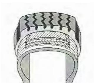
*Figura 5: Neumático Radial. Fuente: (Gallardo Bastidas 2013)*
