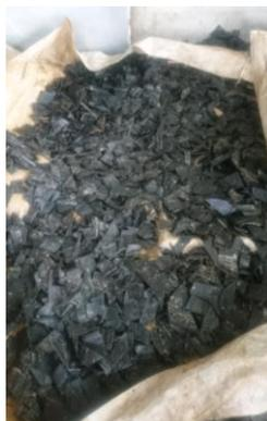
*Figura 18:Material a obtener para ingresar a una Trituradora de Martillo pedazos de 4x4cm. Fuente: [OQ Cauchos].*
