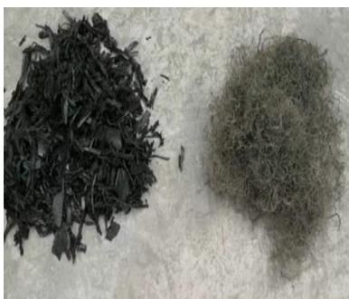
*Figura 20:Productos obtenidos Caucho y Alambre. Fuente: [OQ Cauchos].*
