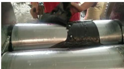
*Figura 17: Laminado de Caucho. Fuente: [OQ Cauchos].*
