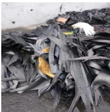
*Figura 11: Breaker (Cimas de caucho entretrejidas con alambre). Fuente: [OQ Cauchos].*
