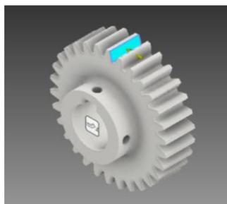
Figura 73: Fuerza tangencial sobre el diente de la Rueda Dentada. Fuente: [Autor].
