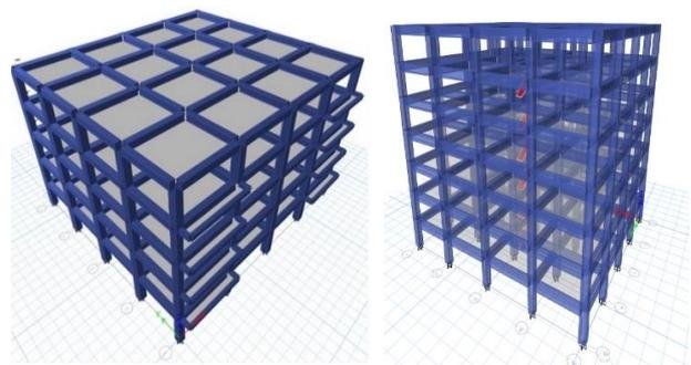
Figura 5. Modelos tridimensionales de concreto armado del edificio 1 (A) y edificio 2 (B).
