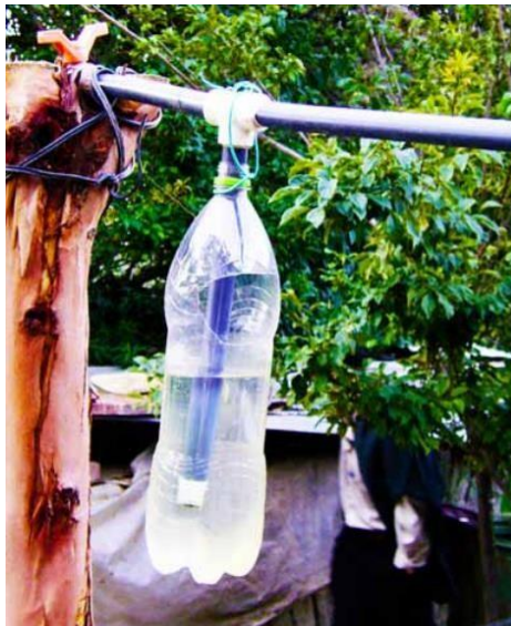
Figura 4. Válvula para salida de biogás excedente fabricado con una botella de plástico [26].
