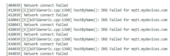
Figura 33. Desconexión entre el módulo ESP32 y Cayenne
