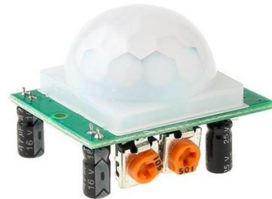
Figura 3. Sensor Movimiento PIR HC-SR501
