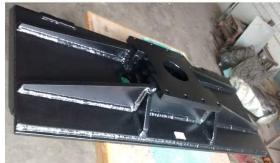
Figura 15. Placa de adaptación como producto final
