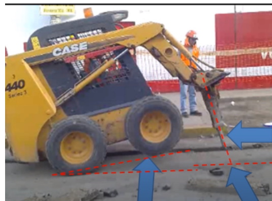
Figura 3. Cargador compacto operando con el martillo hidráulico SB202 [15]
