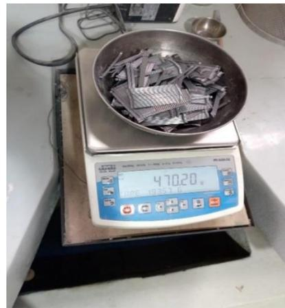
Figura 2. Dramix 3D previo al ensayo en laboratorio.
