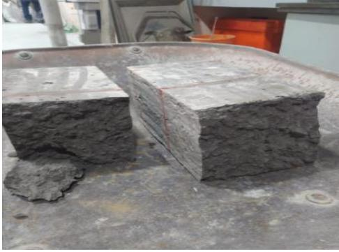
Figura 10. Falla sin fibras de acero.
