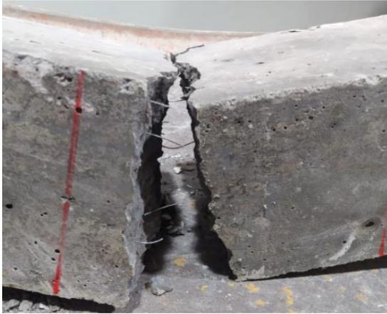
Figura 11. Falla con fibras de acero.
