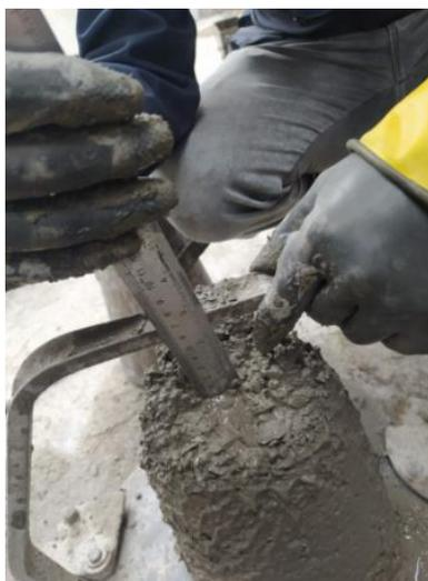
Figura 4. Medición del asentamiento con la ayuda de una regla metálica.
