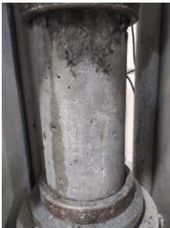
**Figura 6.** Falla típica en el ensayo a compresión.
