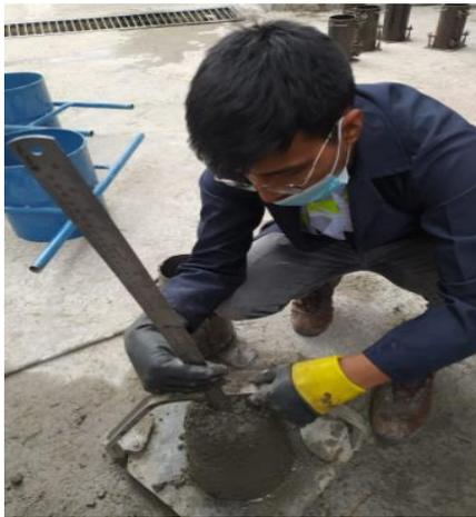
Figura 3. asentamiento en el laboratorio de ingeniería civil.
