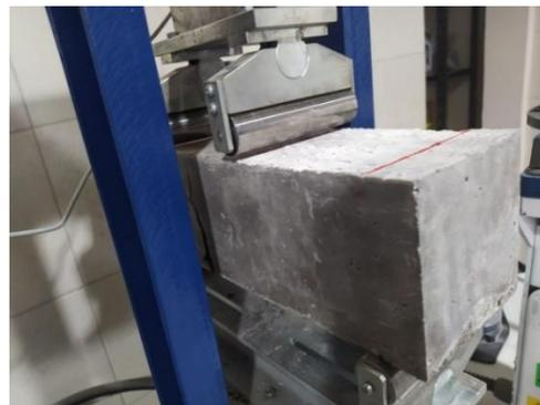
**Figura 9.** Ensayo a flexión incluyendo fibras de acero.
