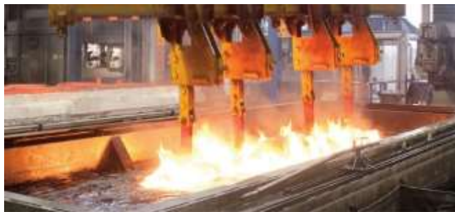
Figura 14. Barra térmica en el tratamiento térmico de temple [24].
