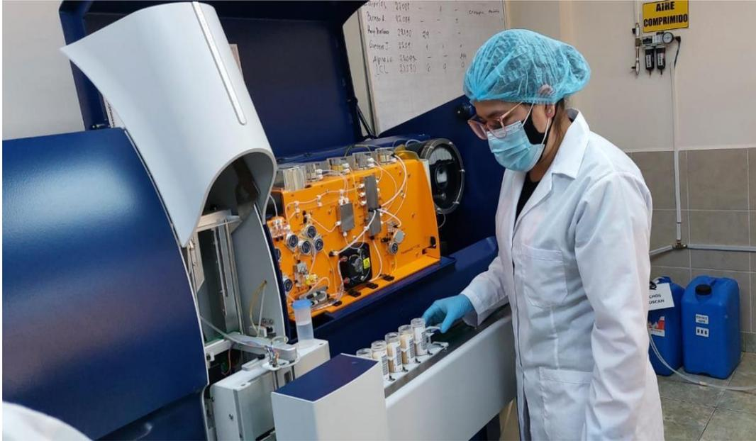
**Anexo 3** *Conteo de células somáticas diferenciales (CCSD) mediante citometría de flujo, en el equipo FOSSOMATIC 7DC.*
