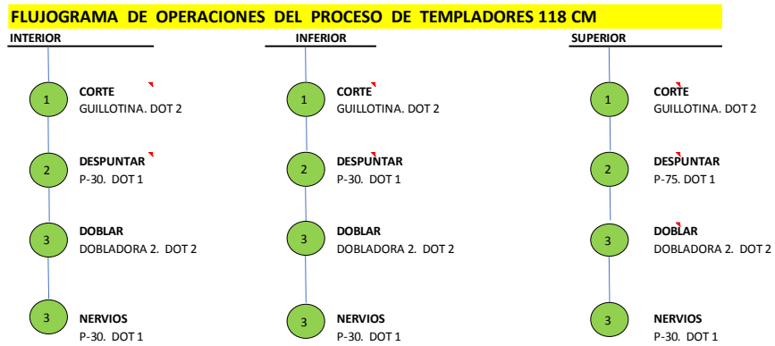
Figura 18 Diagrama de flujo para la elaboración de una góndola (tapa lateral de base)
