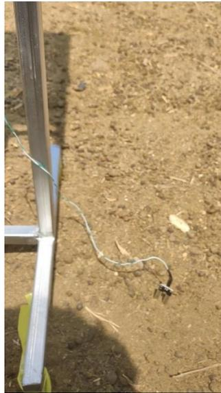
**Fig. 42** Obteniendo valores de humedad de suelo.
