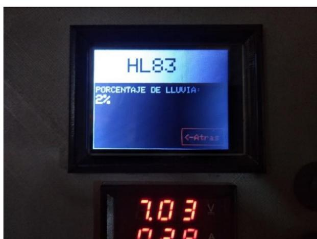
**Fig. 45** Visualización sensor de lluvia
