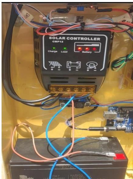
**Fig. 40** Controlador de carga.
