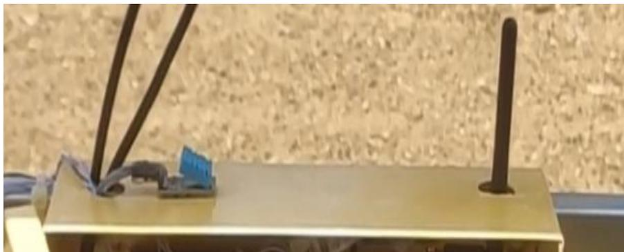
**Fig. 38** Sensor DHT11 instalado en el exterior de la estructura.
