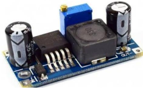
**Fig. 12** Módulo de convertidor de voltaje DC con chip regulador LM596 [16]
