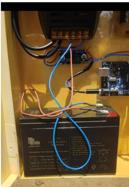
**Fig. 41** Batería conectada al módulo de carga.
