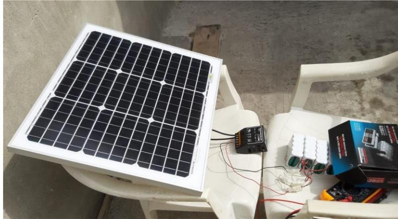
**Fig. 33** Conexión de módulo de carga y panel solar.
