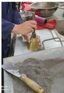
Figura 6: Densidad del agregado fino
