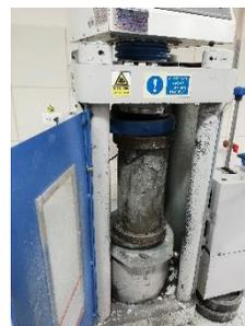
Figura 9. Ensayo de resistencia a la compresión.
