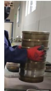
Figura 3: Tamizado manual del ladrillo triturado
