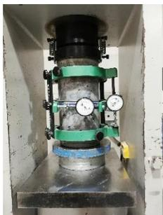
Figura 11. Ensayo de módulo de elasticidad.
