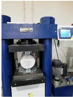
Figura 10. Ensayo de resistencia a la tracción indirecta
