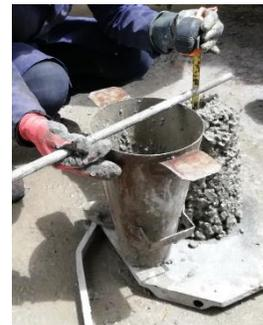
Figura 8. Método del cono de Abrams.
