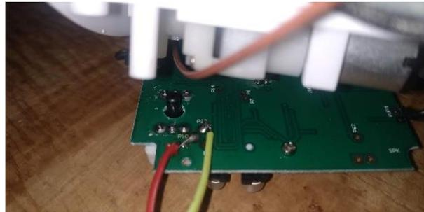
**Figura 17:** Modificación del monitor de tensión arterial (Cable amarillo: SDA, cable rojo: SCL y cable marrón: Negativo)
