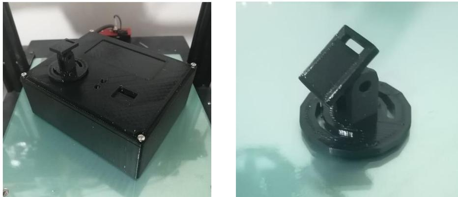
**Figura 33:** Impresión 3D de la carcasa (a. Carcasa ensamblada b. Soporte para el sensor de temperatura)
