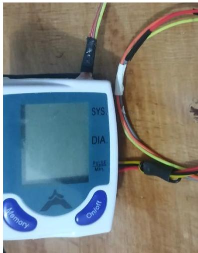
**Figura 18:** Monitor de tensión arterial sellado luego de la modificación.
