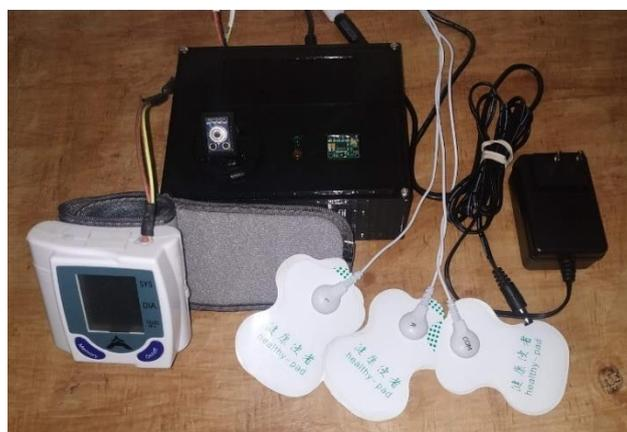
**Figura 34:** Módulo de telemedicina completamente ensamblado
