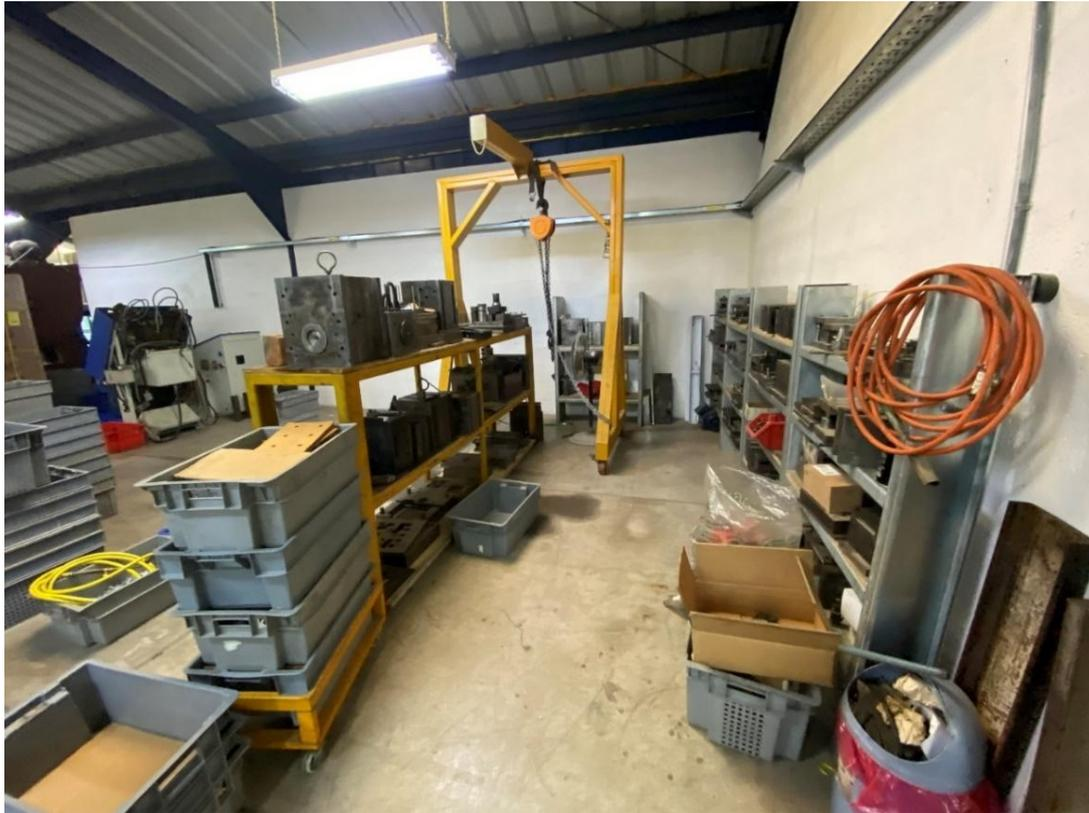
**Fotografía 10.** Falta de limpieza y orden en almacenaje de moldes de inyección.
