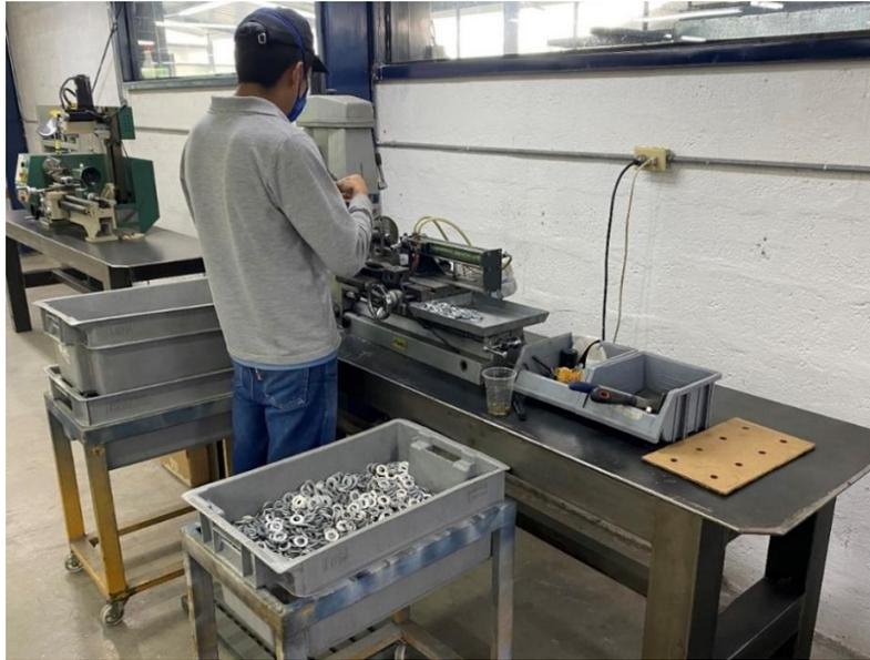
**Fotografía 9.** Eliminación de rebaba diámetro exterior Inner Wheel.
