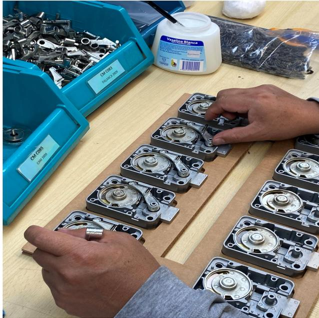
**Fotografía 5.** Ensamblaje de cerradura de combinación.
