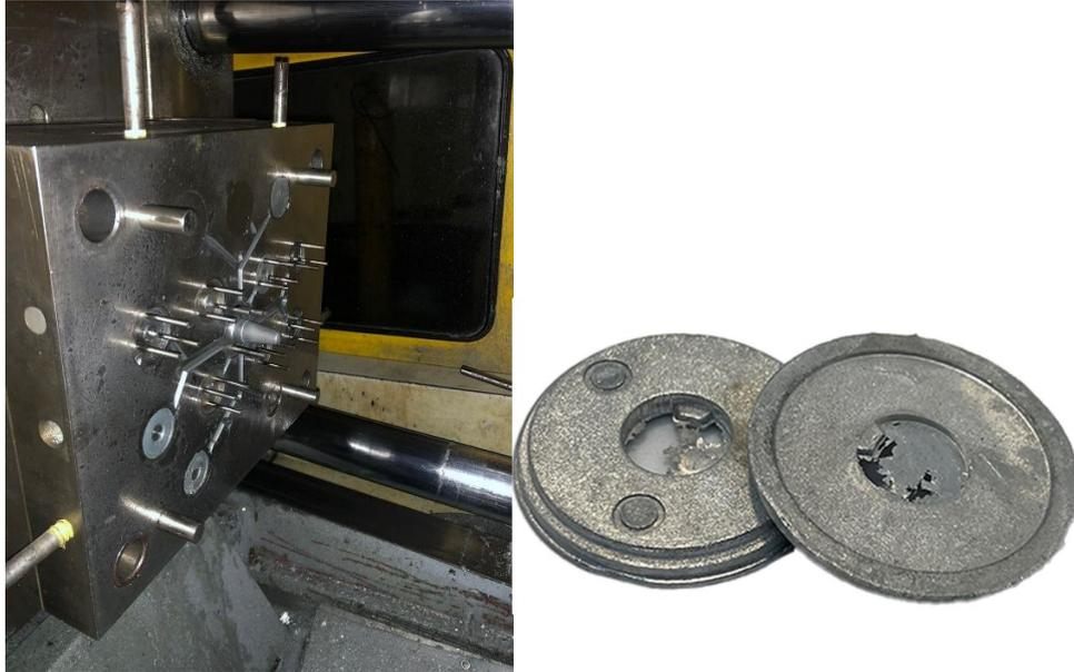
**Fotografía 7.** Molde de inyección y rebabas de componentes Inner Wheel.
