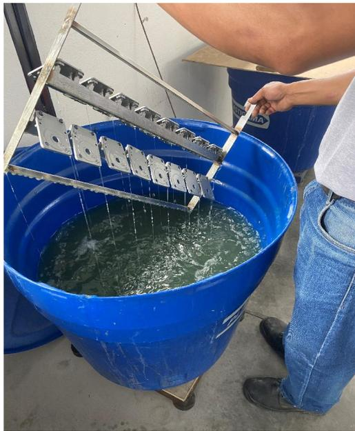
**Fotografía 4.** Baño de laca al componente cover de la cerradura de combinación.
