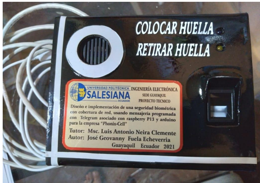
Figura 3. 5: Diseño final de la caja del biométrico
