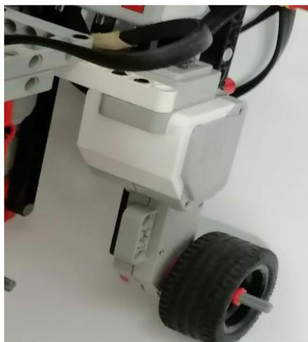
**Figura 20: Foto del motor large motor y llantas del kit Lego Mindstorms**
