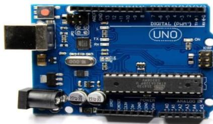
**Figura 10: Placa Arduino Uno**
