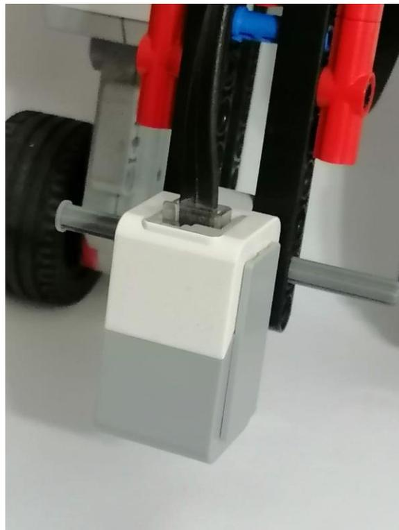
**Figura 23: Foto del sensor de color del kit de Lego Mindstorms**
