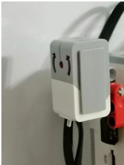
**Figura 18: Foto del sensor de Gyro de lego Mindstorms.**
