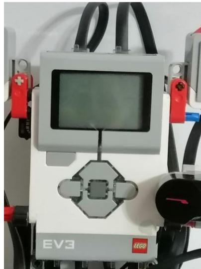
**Figura 21: Foto del brick y sensor infrarrojo de distancia de Lego Mindstorms**
