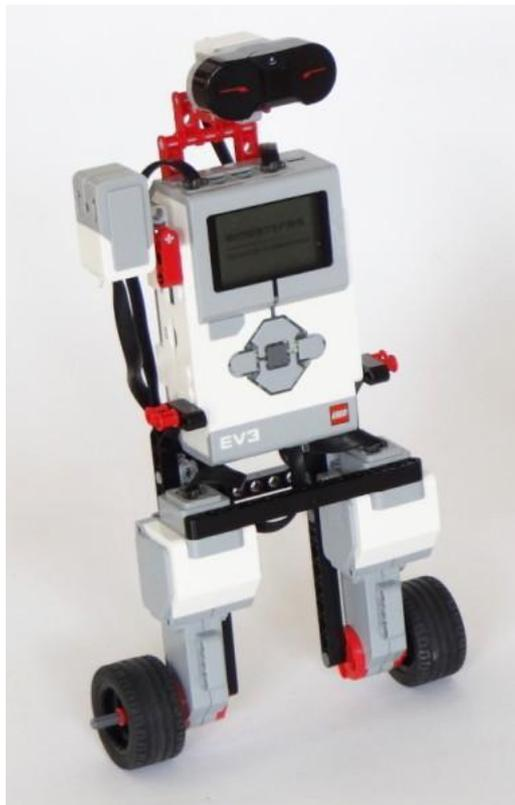
**Figura 14: Foto del robot denominado BALANCER EV3.**
