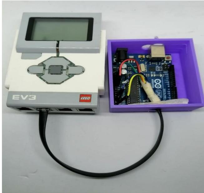
Figura 24: Foto del segundo brick y el Arduino Uno
