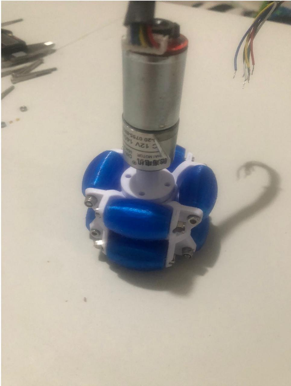
Figura 56. Ruedas omnidireccionales impresas en 3D
