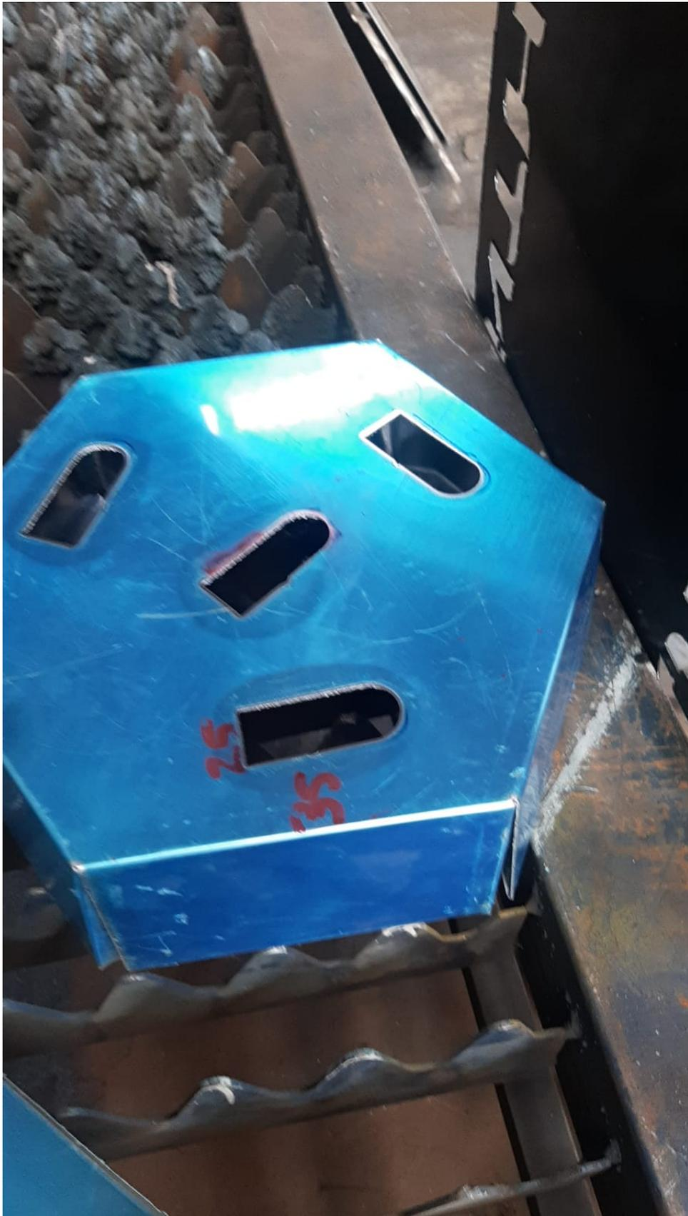
Figura 55. chasis de la estructura del robot
