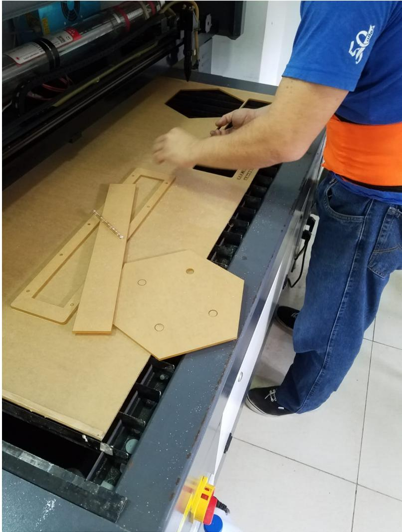
Figura 63. Proceso de corte de base de acrílico
