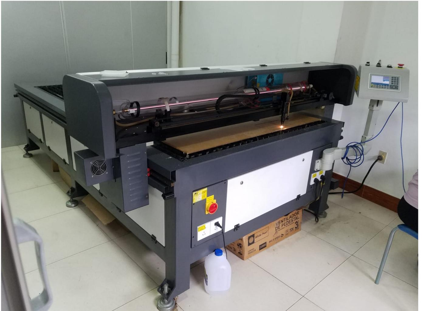
Figura 64. CNC láser realizando cortes de piezas
