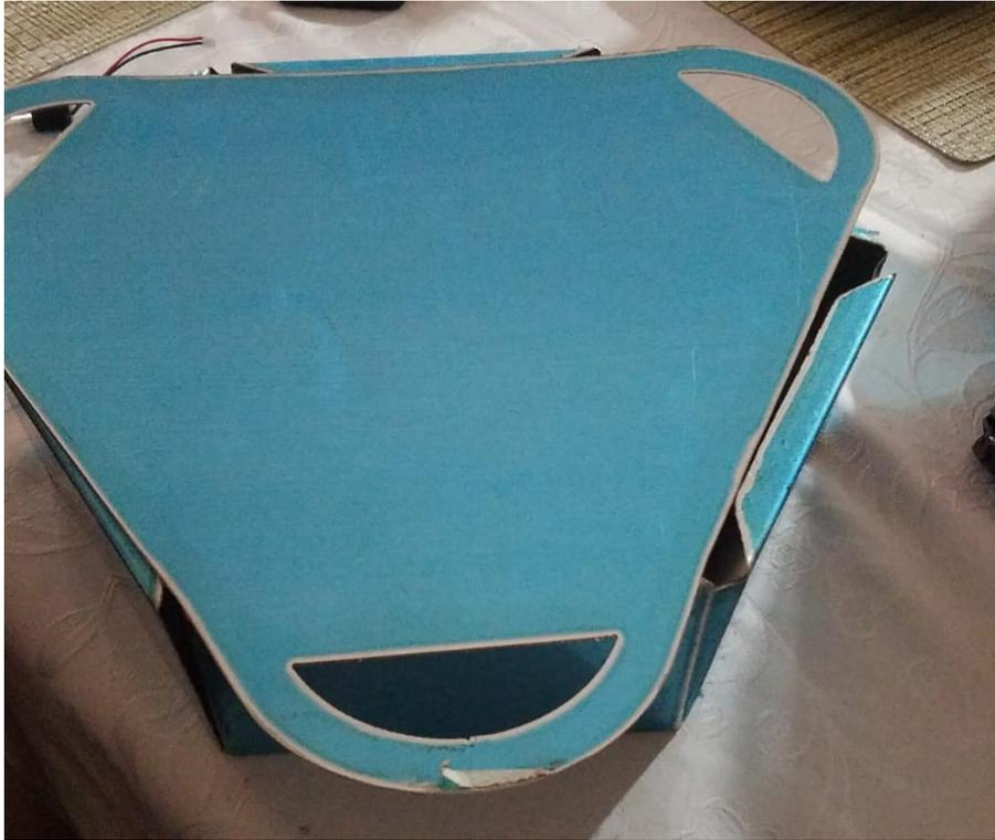
Figura 67. Montaje de tapa ubicada en la parte superior del chasis
