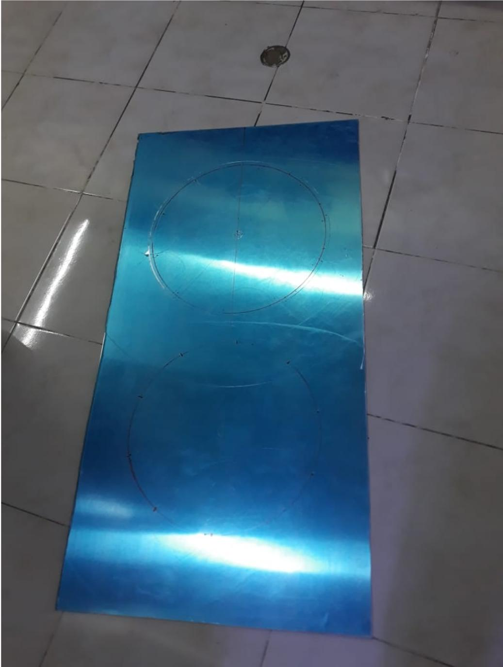
Figura 66. Plancha de aluminio destinada a ensamblaje del robot
