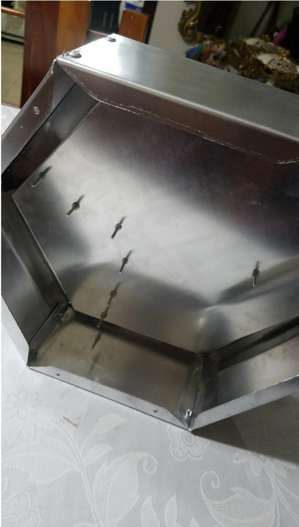
Figura 72. Montaje de soporte de luces UV y tarjetas de control de lamparas
