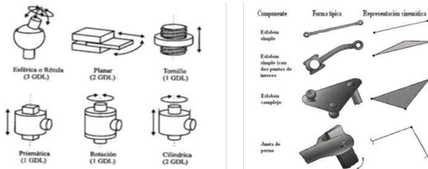
Figura 10. Tipos de articulaciones y eslabones usados en la robótica.
