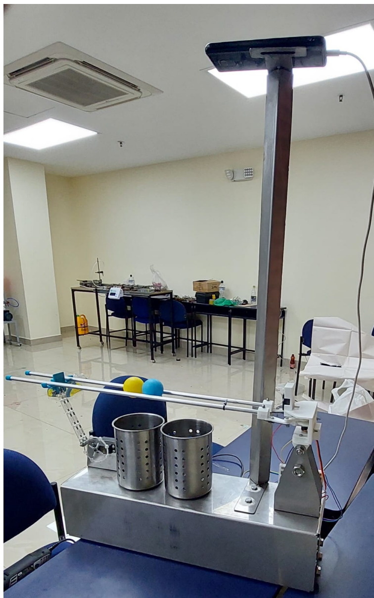
Figura 36. Módulo clasificador longitudinal de 2 grados de libertad, por C. Mora y C. Granda.
