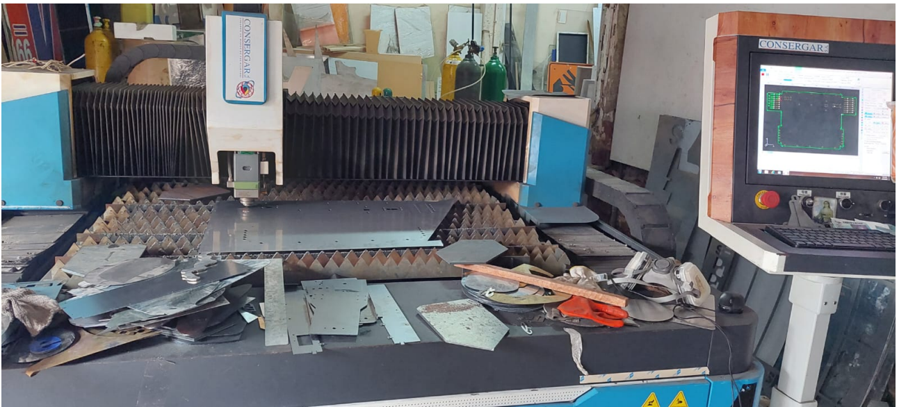
Figura 83. Corte láser de la estructura metálica
