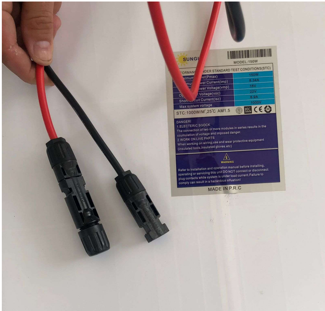
Figura 66. Conectores impermeables del panel solar
