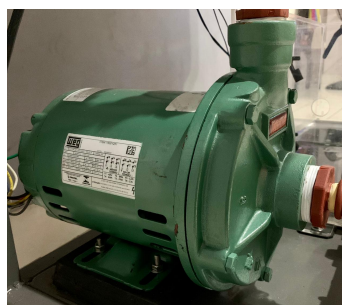
Figura 27. Bomba trifásica de 1/2 hp. fuente: autores
