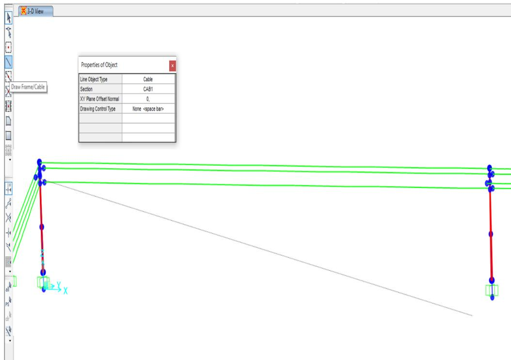
Figura 5.3: Vano de dos postes con estructura tipo Line Post
