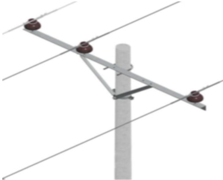
Figura 5.13: Estructura Trifásica Semi centrada, Pasante o Tangente.-
