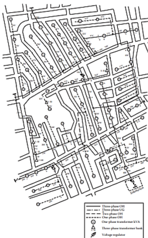
Imagen 5. Esquema de un sistema de distribución unifilar [6]
