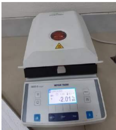
Ilustración 3: Porcentaje de humedad mediante la Balanza Halógena
