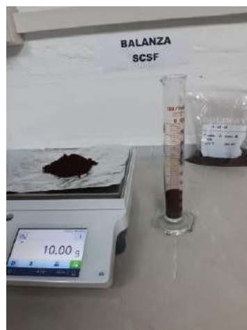
Ilustración 6: Prueba de la densidad mínima aparente y por asentamiento
