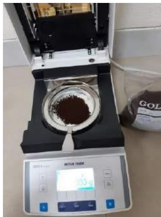
Ilustración 5: Determinación de humedad por tamaño de partícula de la materia prima
