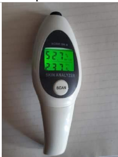
Analizador digital SK-8 con datos del porcentaje de humedad y porcentaje de aceite en la piel
