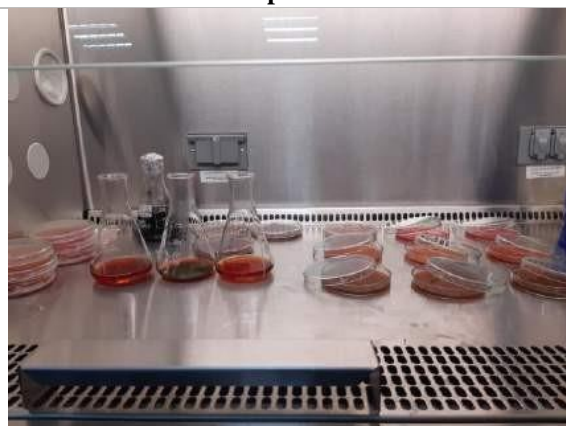
Técnica vertido en placa, esperando la solidificación de los agares
