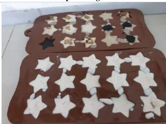
Jabones colocados en los respectivos moldes para su posterior solidificación
