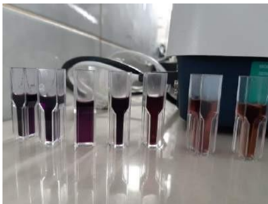
Ilustración 16: Soluciones de DPPH en celdas para espectrofotómetro
