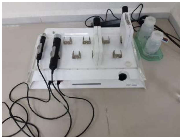
Uso del equipo Corneómetro® para el análisis de humedad presente en la piel
