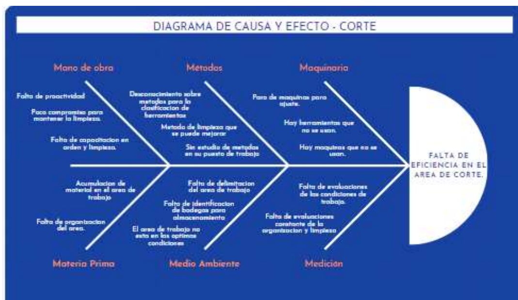
FIG. 4. DIAGRAMA CAUSA-EFECTO SOBRE LA PROBLEMÁTICA EN EL ÁREA DE CORTE.
