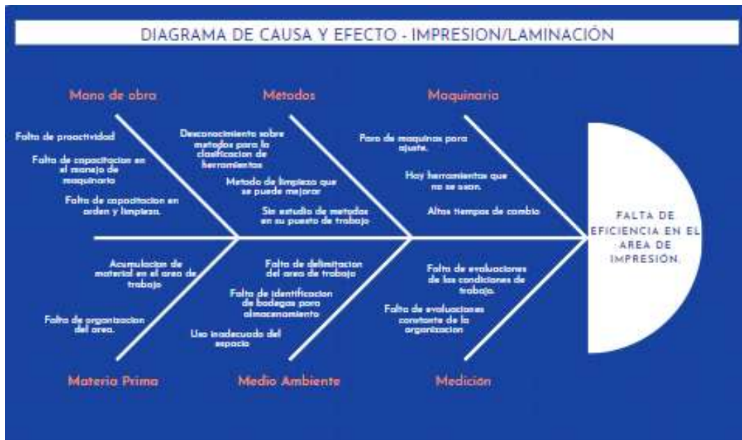
FIG. 2. DIAGRAMA CAUSA-EFECTO SOBRE LA PROBLEMÁTICA EN EL ÁREA DE IMPRESIÓN.
