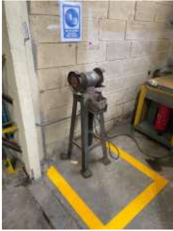
FIG. 55. LÍNEA DE SEGURIDAD PARA USO DE ESMERIL EN ÁREA DE EXTRUSIÓN.
