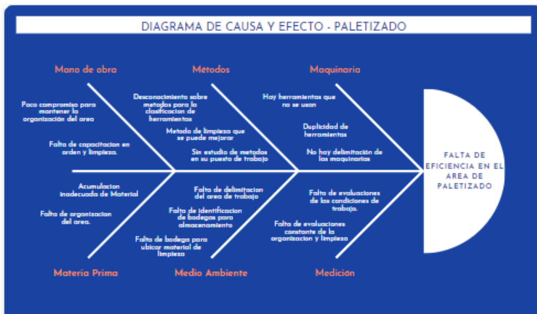
FIG. 7. DIAGRAMA CAUSA-EFECTO SOBRE LA PROBLEMÁTICA EN EL ÁREA DE PALETIZADO.
