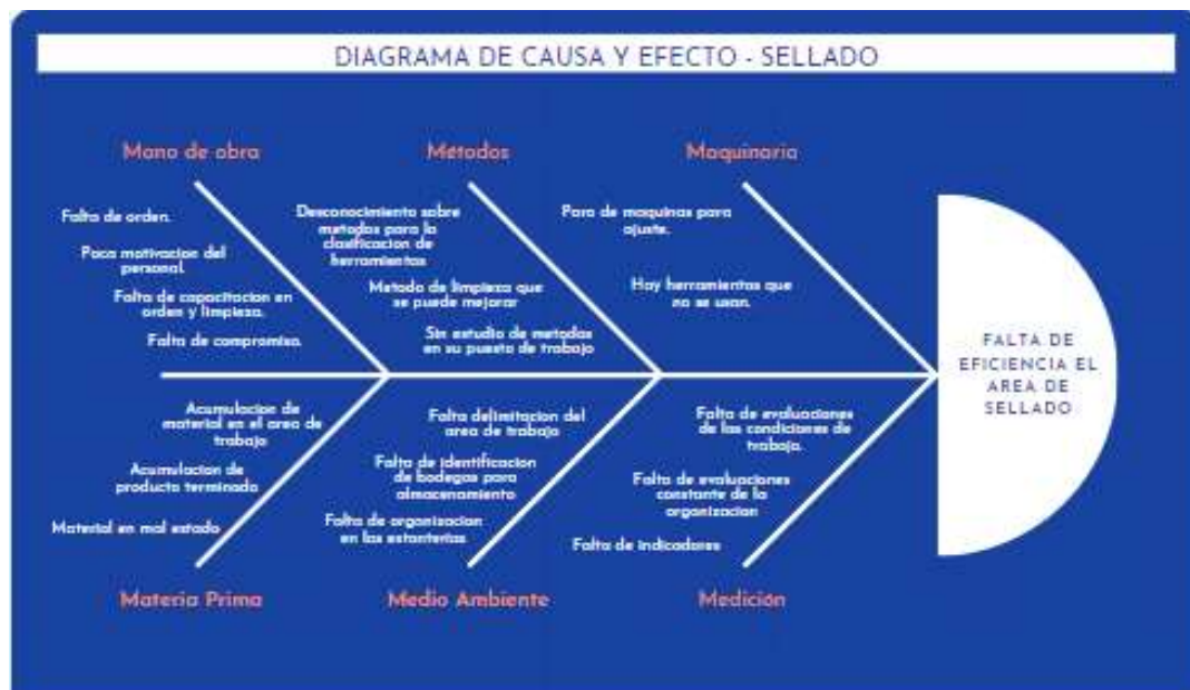
FIG. 5. DIAGRAMA CAUSA-EFECTO SOBRE LA PROBLEMÁTICA EN EL ÁREA DE SELLADO
