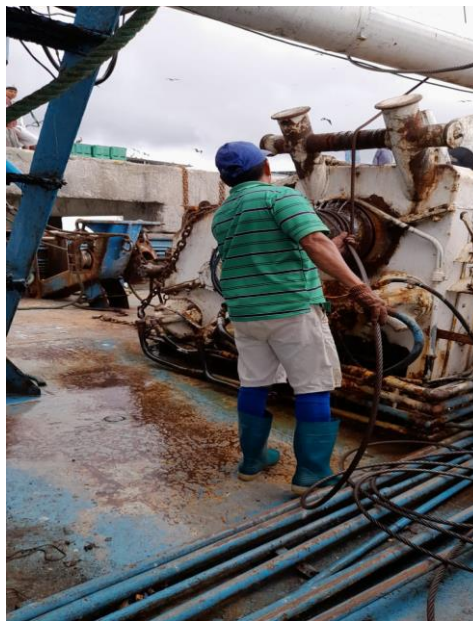
Figura 10. Maniobra de largado (cabestral o winche)
