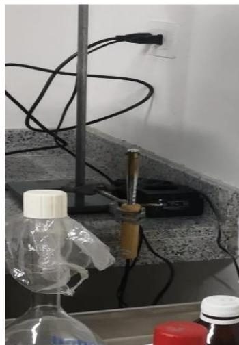
*Figura 4. Pin portaobjetos siendo precalentado para la deposición de la muestra.*
