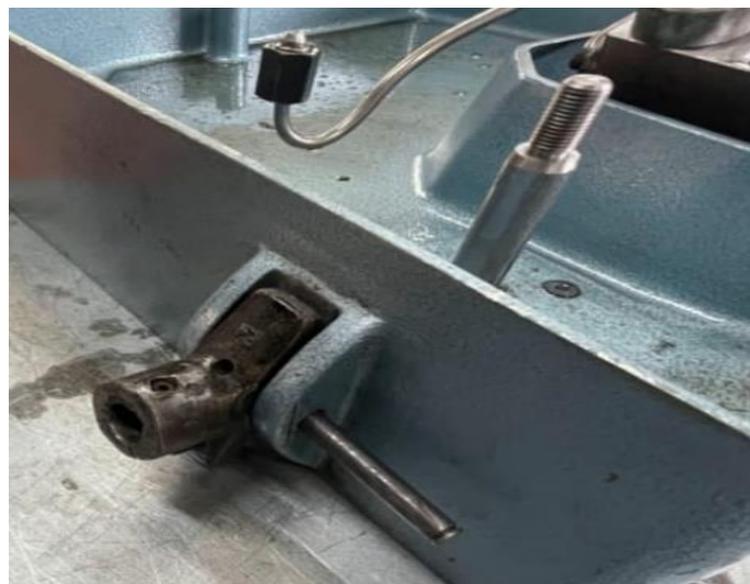
Figura 58 Mecanismo de la manivela.
