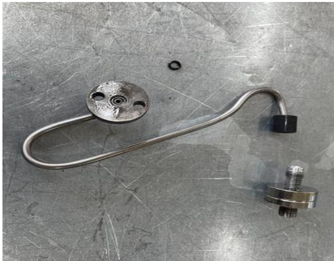
Figura 45 Desarme de los retenes de la válvula de control de combustible.
