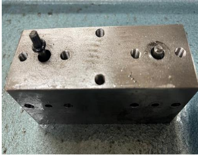
Figura 44 Liberación del eje de la válvula.
