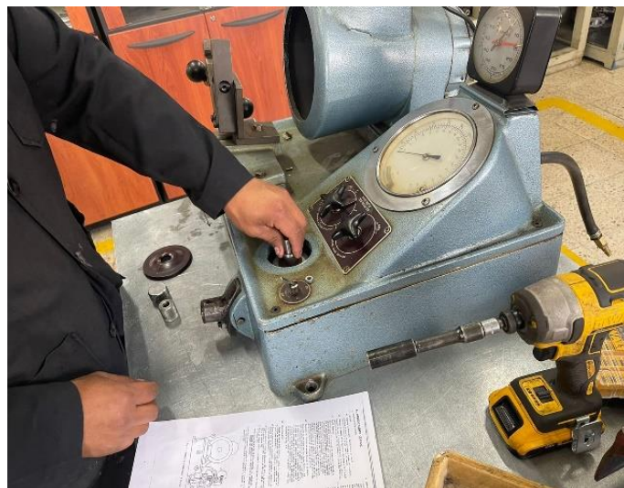
Figura 51 Desarme del tapón de llenado.
