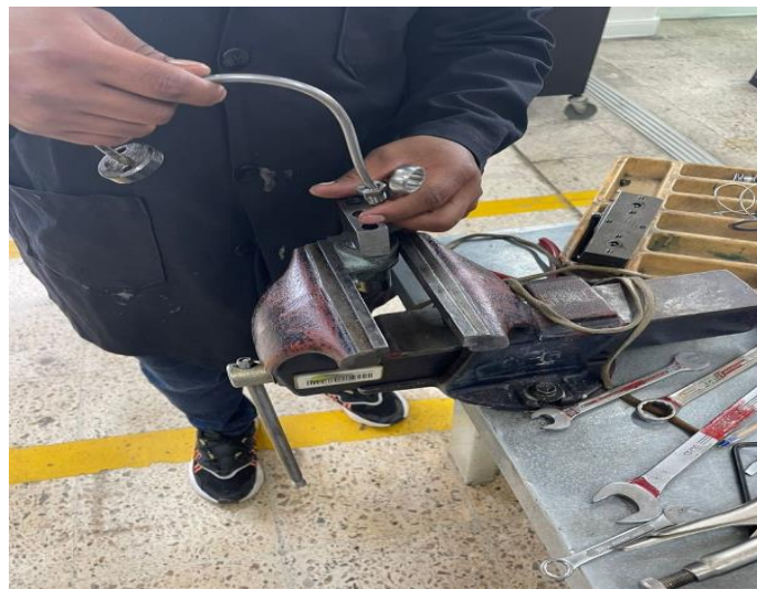
Figura 48 Desmontaje del bloque de acople.
