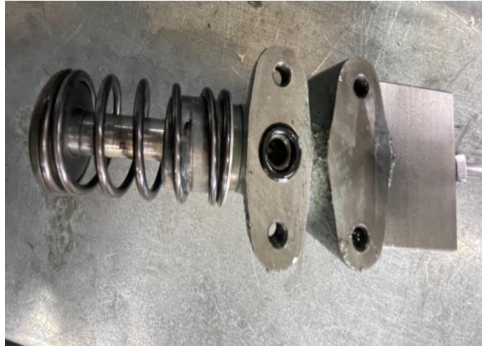
Figura 6 Bomba de presión.
