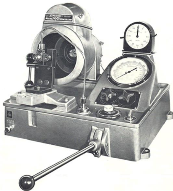
Figura 2 Comprobador Hartridge HH601 diésel mecánico.
