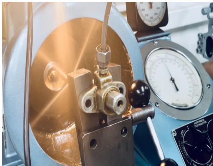
Figura 81 Instalación del inyector y prueba de presión.
