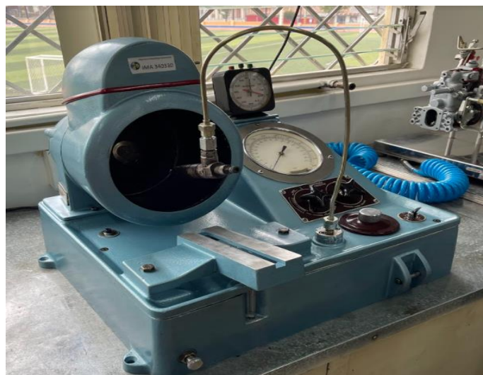
Figura 82 Comprobador HH601 restaurado.
