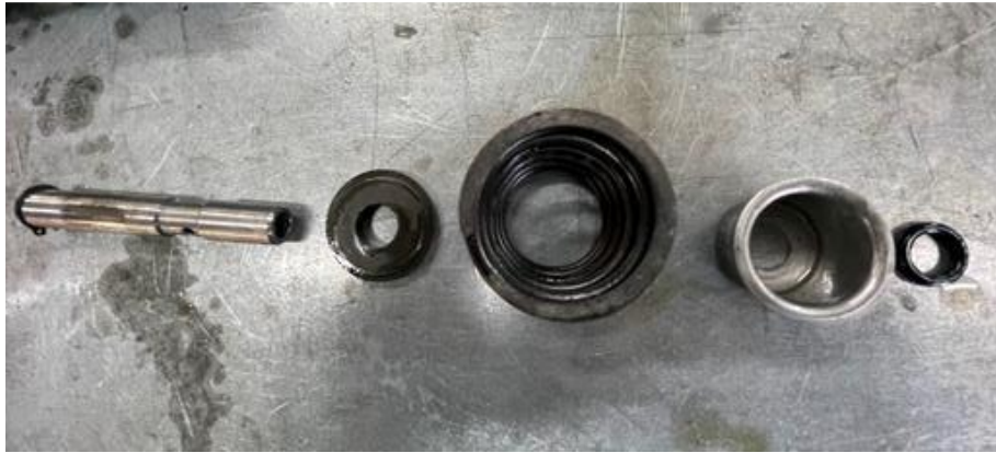
Figura 49 Despiece de los componentes de la bomba.
