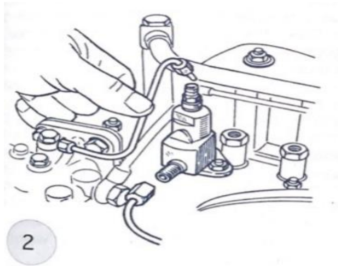
Figura 27 Desmontaje de la cañería de rebose.
