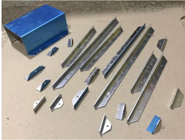
Figura 30. Fabricación de Ángulos de Soporte
