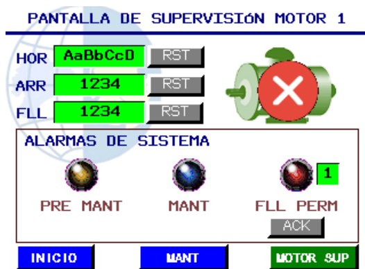
Figura 57. Pantalla de supervisión HMI.
