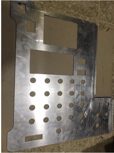
Figura 28. Plafón Superior. Corte en máquina CNC
