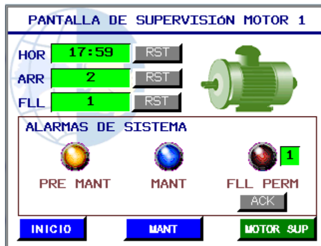
Figura 91. Pantalla de supervisión HMI.
