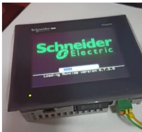
Figura 40. HMI GTO2310 energizado y encendido
