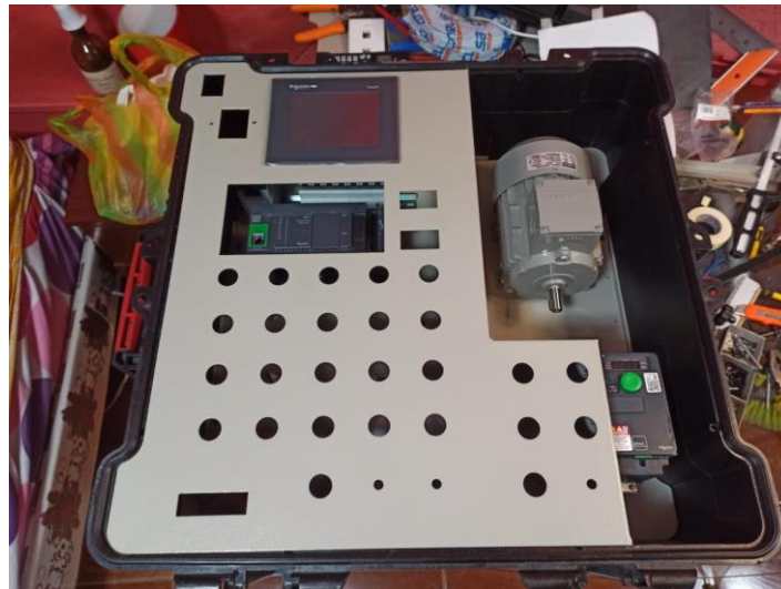
Figura 84. Ensamble de equipos dentro de la maleta didáctica
