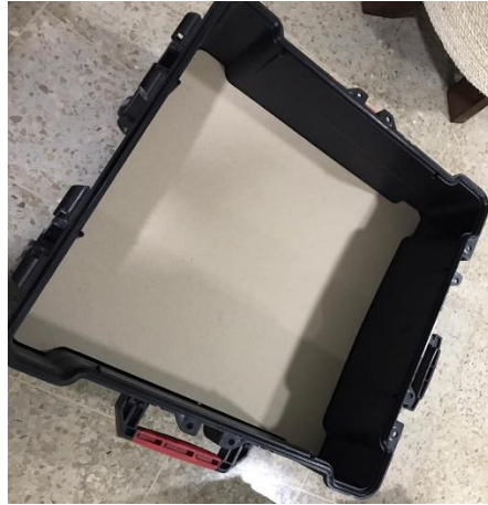
Figura 24. Plafón Inferior. Elaborado en cartón prensado
