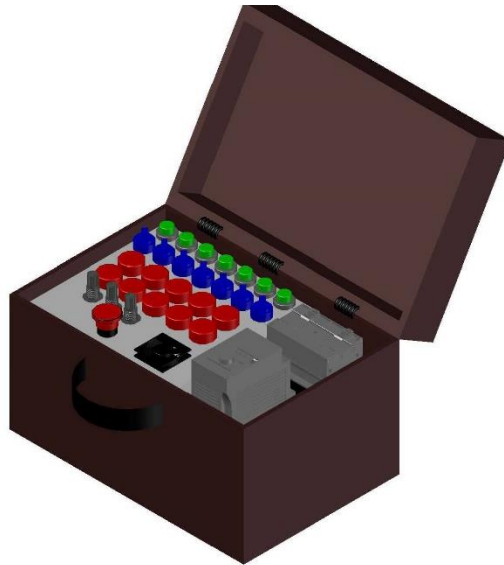
Figura 15. Diseño 3D de Maleta Didáctica, Primera versión
