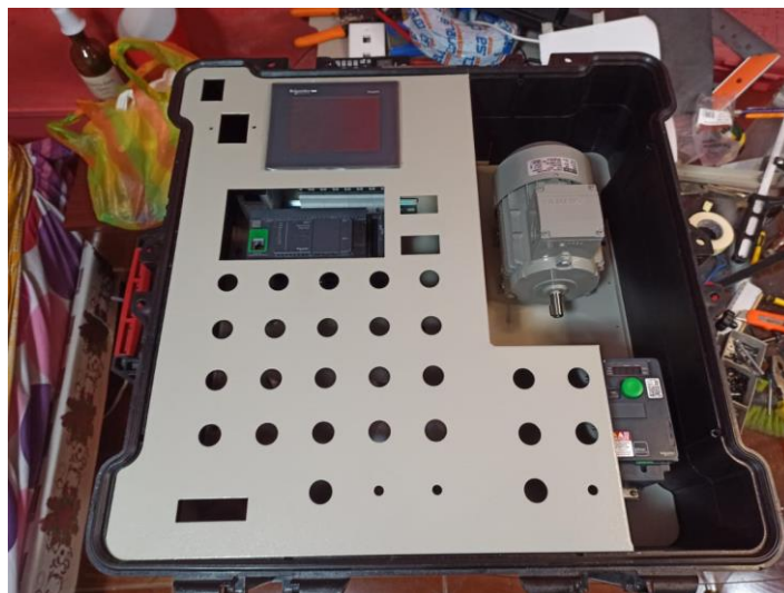
Figura 46. Instalación de HMI GTO2310
