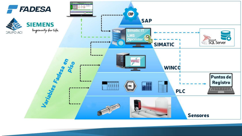
Figura A.1 Arquitectura de comunicación
